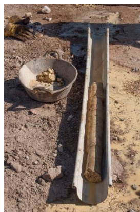
Foto 3: Testigo de sondeo durante las labores de recuperación y en caja
