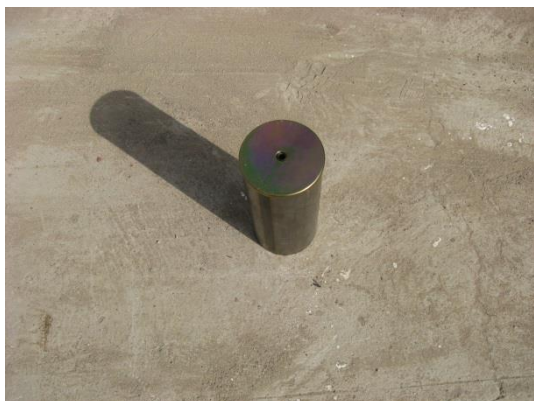
Foto 2: Acondicionamiento de los sondeos con tubo de PVC y cierre metálico
