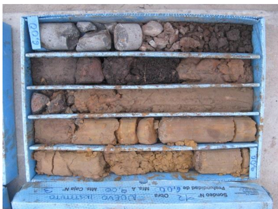
Foto 3: Testigo de sondeo durante las labores de recuperación y en caja
